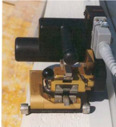
Machine automatique de soudure à coin chauffant
