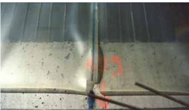
Esta imagen muestra visualmente que la soldadura es de buena calidad. La soldadura es más transparente que el área del canal de prueba; pero a la vez las marcas negras al principio de la soldadura demuestran que, o bien la temperatura era muy alta, o que no se había limpiado adecuadamente la cuña caliente. En tal caso, una investigación especial sobre la calidad de la soldadura en esta área se puede realizar inmediatamente. Con una membrana opaca estos defectos no se verían.
