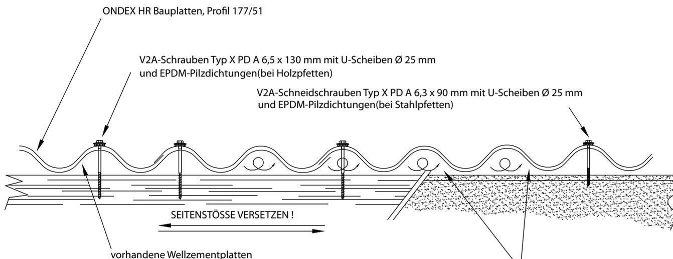
AUF AUSREICHENDE BE- UND ENTLÜFTUNG UNTERHALB DER VORHANDENEN WELLZEMENT-PLATTEN IST ZU ACHTEN
