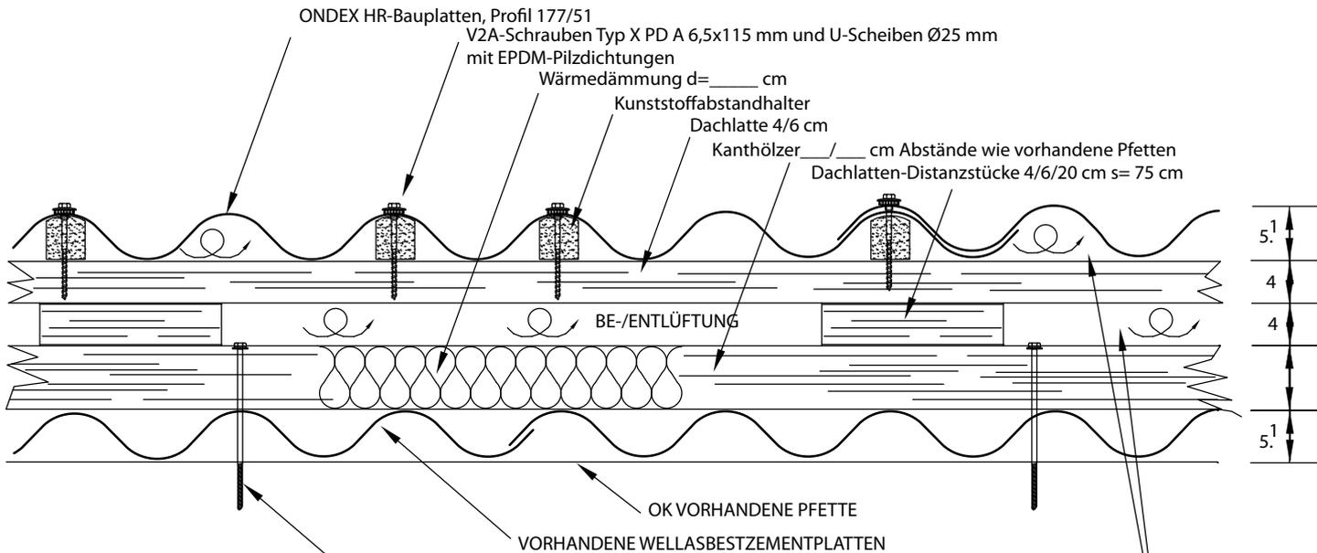
VERZ. SCHRAUBEN Typ VS 16 A 6,5x\_\_\_ mm (bei HOLZPFETTEN)
