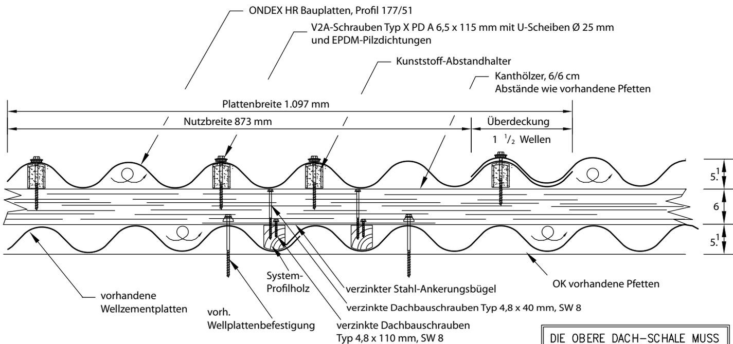
DIE OBERE DACH-SCHALE MUSS IN AUSREICHENDEM MASSE BE- UND ENTLÜFTET WERDEN
