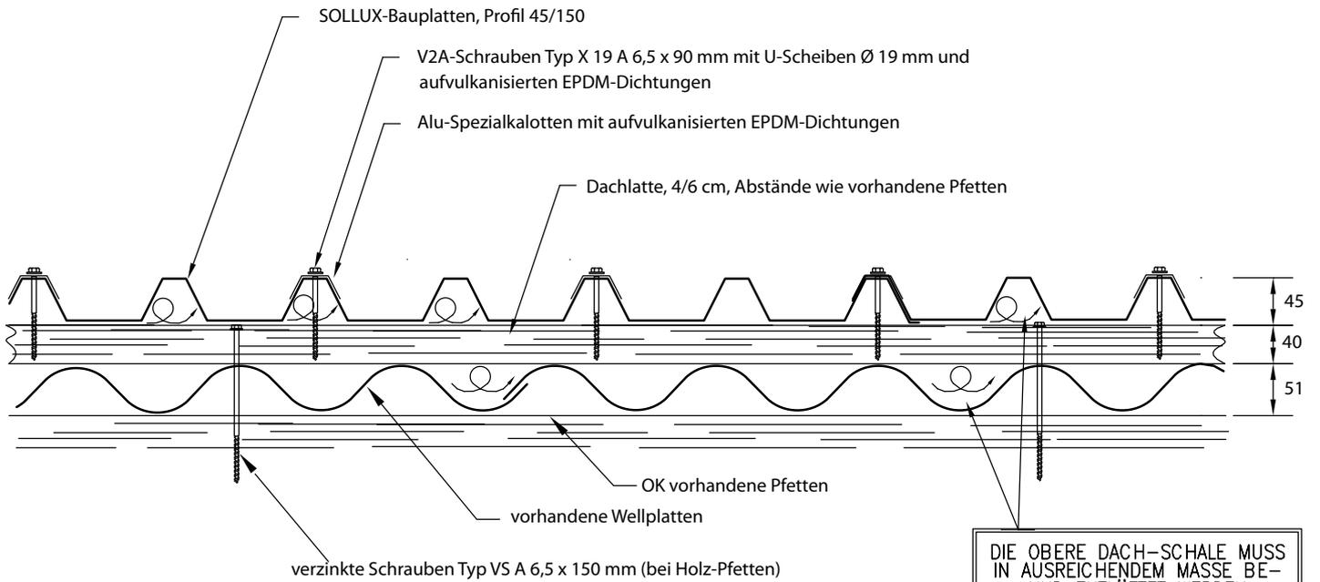
DIE OBERE DACH-SCHALE MUSS IN AUSREICHENDEM MASSE BE- UND ENTLÜFTET WERDEN
